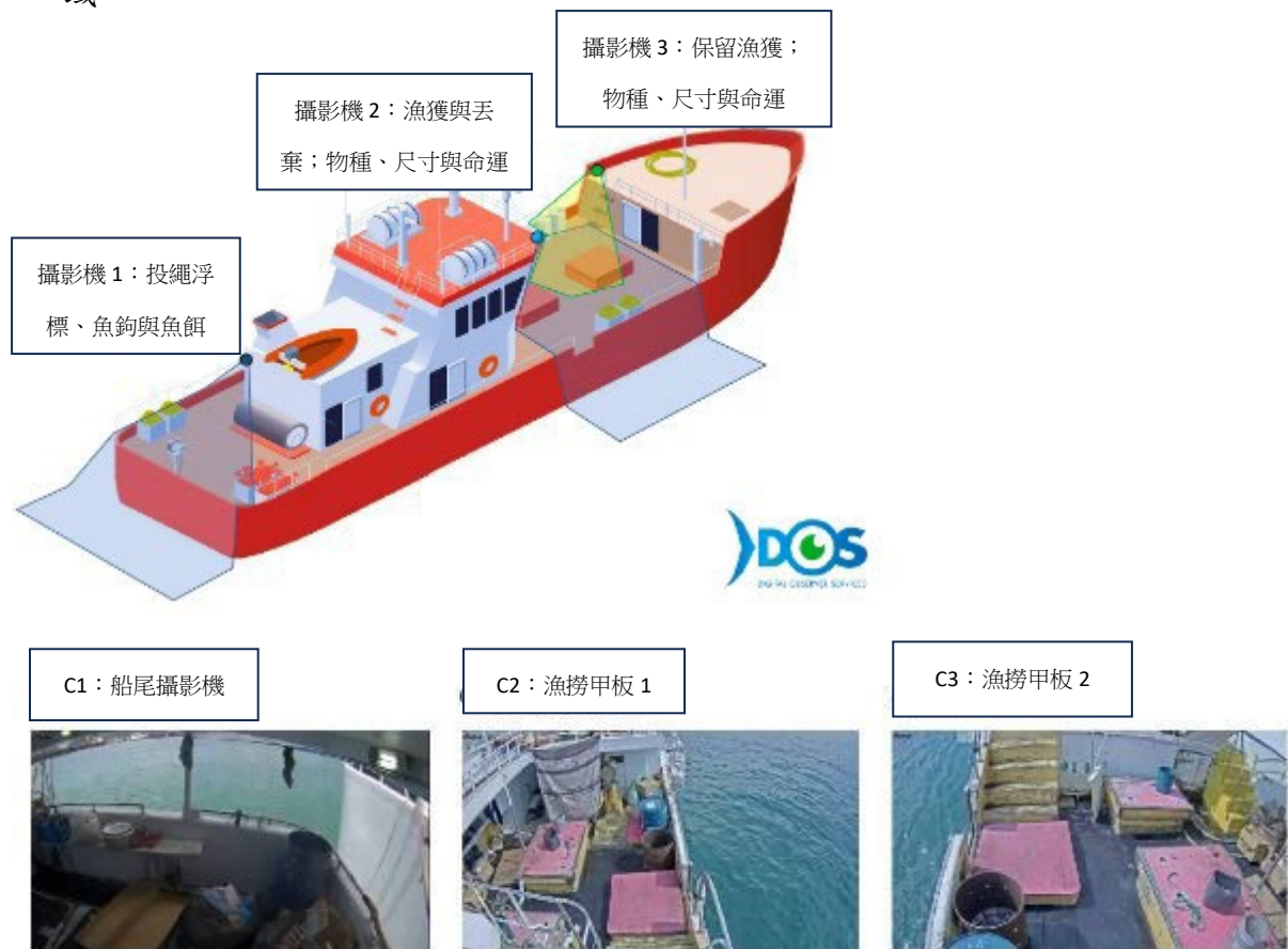
圖 2 延繩釣安裝的 3 台攝影機的示例，涵蓋了漁撈和處理魚類操作的主要區域。三個攝影機的視圖：（左圖）船尾攝影機 - 設置延繩釣，提供有關魚鈎、浮標、避忌技術和餌料的資訊；（中圖）漁撈甲板 1 - 揚繩資訊、捕捉和丟棄、物種識別、大小和命運；（右圖）漁甲板 2 - 物種的命運、大小、物種 ID（來源：Digital Observer Services）
