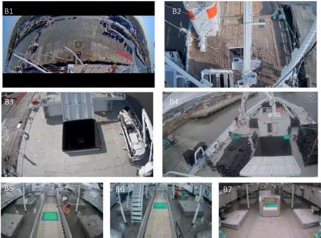
圖 1 (A) 圍網船上安裝的 6 台攝影機 EM 系統示例，其覆蓋漁撈和漁獲處理操作的主要區域（來源：Murua et al., 2020b）；和(B) 安裝在圍網船上的 7 台攝影機 EM 系統（4 台在上甲板，3 台在井圍甲板），覆蓋漁撈和漁獲處理操作的主要區域，包括輸送帶上的 1 台額外攝影機：(B1) 360°全景攝影機（例如，左舷視圖），(B2) 望魚台船尾攝影機，(B3) 工作甲板起重機攝影機視圖，(B4) 前甲板視圖攝影機，(B5) 輸送帶船尾攝影機視圖，(B6) 輸送帶中部攝影機，以及(B7) 輸送帶船頭攝影機(來源：Digital Observer Services)。
