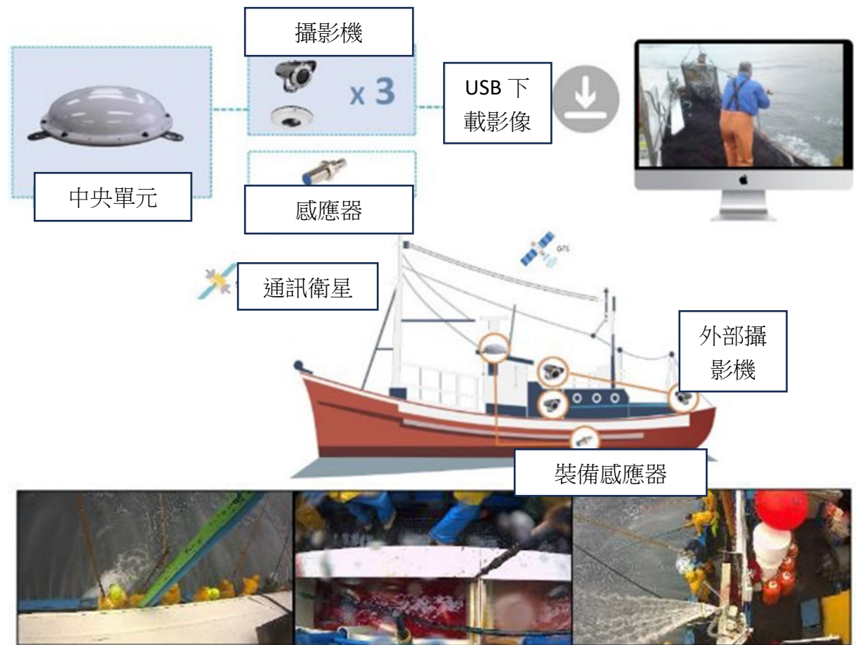
圖 3. 安裝在比斯開灣(Bay of Biscay) (大西洋) 竿釣漁船上的 3 台攝影機電子監測裝置的示例，其涵蓋主要的捕撈活動和魚類處理操作區域。3 台攝影機的視野：（左圖）船尾船橋攝影機 - 竿釣活動；（中圖）魚類處理 - 漁獲儲存；（右圖）船頭船橋攝影機 - 誘餌和竿釣漁撈活動（來源：Marine Instrument）。
